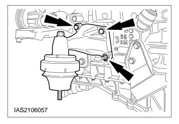
44. Undo the top right-hand flange bolt.
